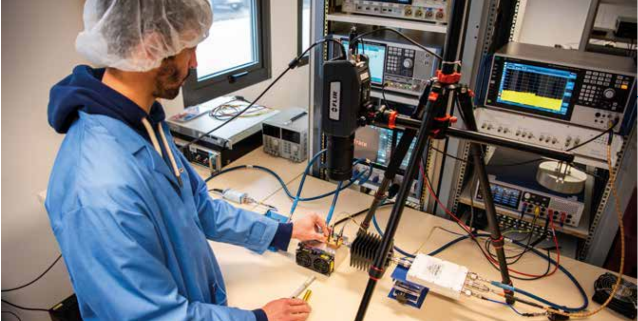
Banc de tests pour amplificateurs Radio 5G
