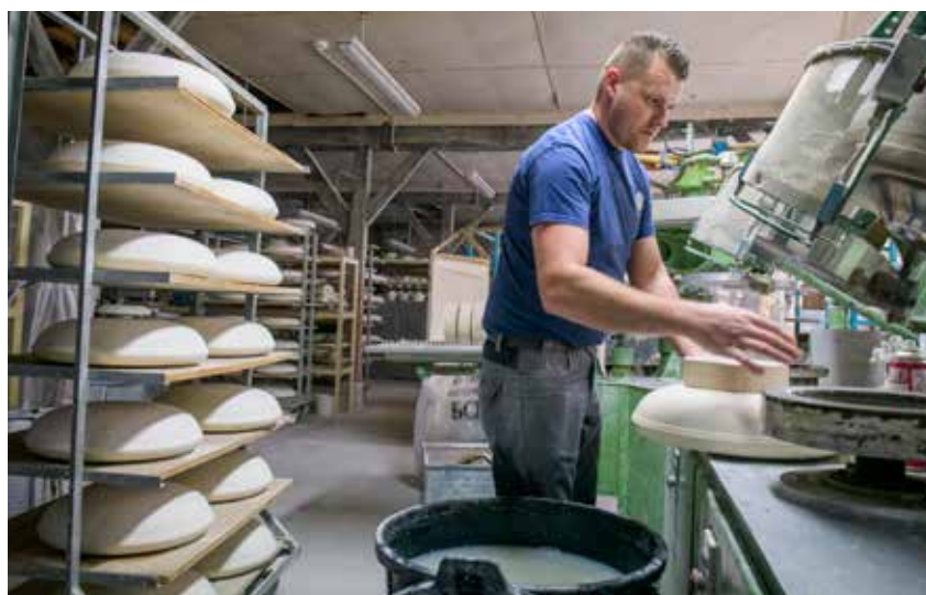
Le calibrage Roller est un procédé qui permet de réaliser des pièces de forme circulaires : assiettes, plats ronds, saladiers, bols,...
