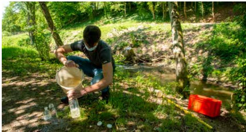
Yoann Guitton, du laboratoire municipal des eaux analyse les prélèvements réalisés dans l'Aurence. Trois points de contrôle sont nécessaires : en amont de plan d'eau, en aval du bassin de décantation et en aval au parc du Moulin Pinard.
