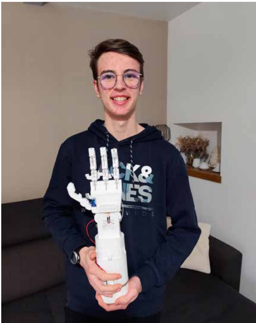
C'est en partant du constat que les prothèses coûtent chères que Firmin a imaginé New Hand, une main bionique en impression 3D. Des moteurs contrôlent la fermeture de quatre doigts articulés. ©DR
