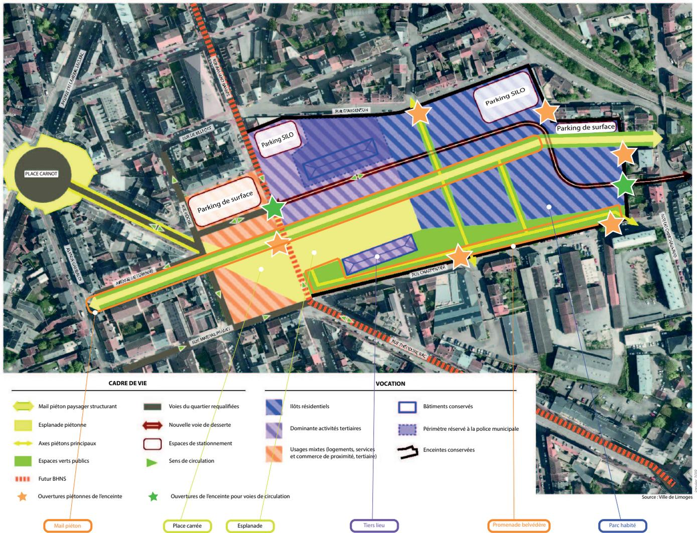
**Parking silo** : Un parc de stationnement en silo est un parking aérien de plusieurs étages. Cette solution est de plus en plus utilisée en alternative au stationnement souterrain car plus rapide à construire (peu de terrassements, éléments préfabriqués...) et moins coûteuse.
